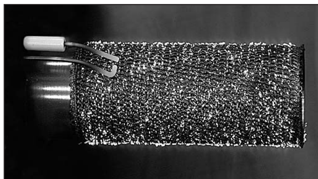
Рис. 14: Горелочная труба с покрытием NIT в действии
